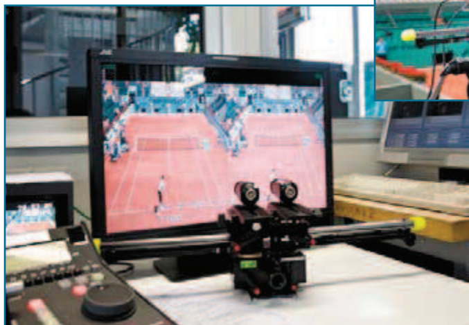
Rolland-Garros : les caméras intègrent 2 objectifs espacés de 7 cm. Les 2 images, côte à côte, sont transmises à une régie d'Orange. Une TV 3D stéréoscopique et des lunettes polarisantes créent la sensation de relief.
