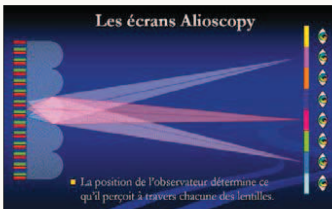
Un composant optique, constitué de micro-loupes, est positionné. Chaque lentille couvre 8 sous-pixels.
